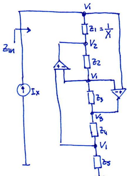
Recordem que la impedància d'entrada és  $V_{in}/I_{in}$ . Per calcular-la poseu una font de corrent a l'entrada i buscareu el quocient per trobar-la.
