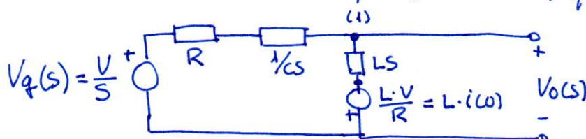
Volem trobar  $V_o(s)$ , així que anem a analitzar el circuit mitjançant un KCL al node (1):
