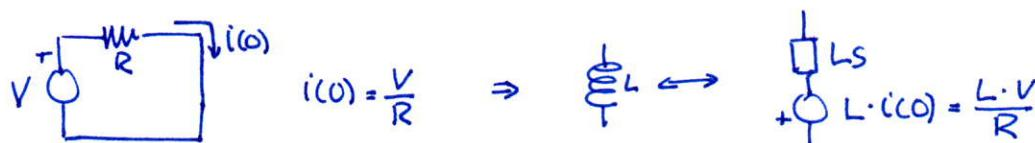
Dibuixeu ara el circuit transformat. Recordeu que, si ens interessa, podríem posar la transformada del condensador i/o de la bobina en la seva forma Norton. Aquí mantenim la Thevenin:
